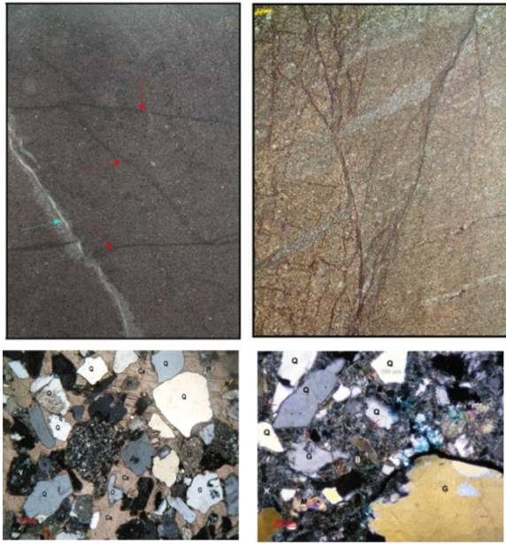
Hình 3. Xi măng và khoáng vật sét lấp nhét trong khe nứt/đứt gãy (hình trên) và lỗ rỗng (hình dưới) (CLJOC, 2007).
